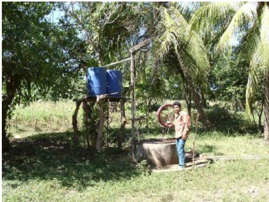
Fotografía 2: Otro sistema con bomba de mecate.
