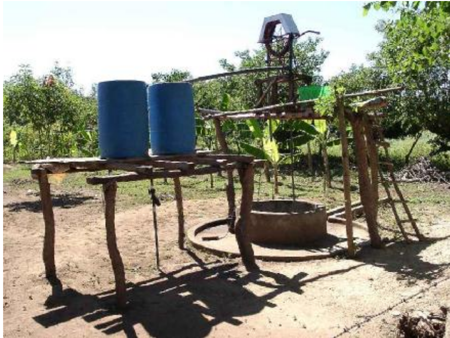
Fotografía 1: El sistema de micro riego (pozo, bomba de mecate, barriles, filtro).
